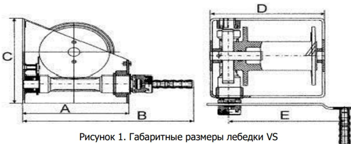
Рисунок 1. Габаритные размеры лебедки VS
